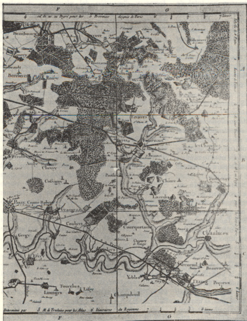
Figura N° 2: Detalle correspondiente a la Carte Géométrique de la France , levantada por la familia Cassini entre los años 1744 y 1789 a escala 1: 86.400. Ella se transforma en el modelo seguido por la mayor parte de los países europeos en sus levantamientos topográficos. Los caminos se representan mediante doble línea y el relieve por medio del método de las normales. Reproducida por R. LISTER, Old Maps & Globes , lámina N° 54.
