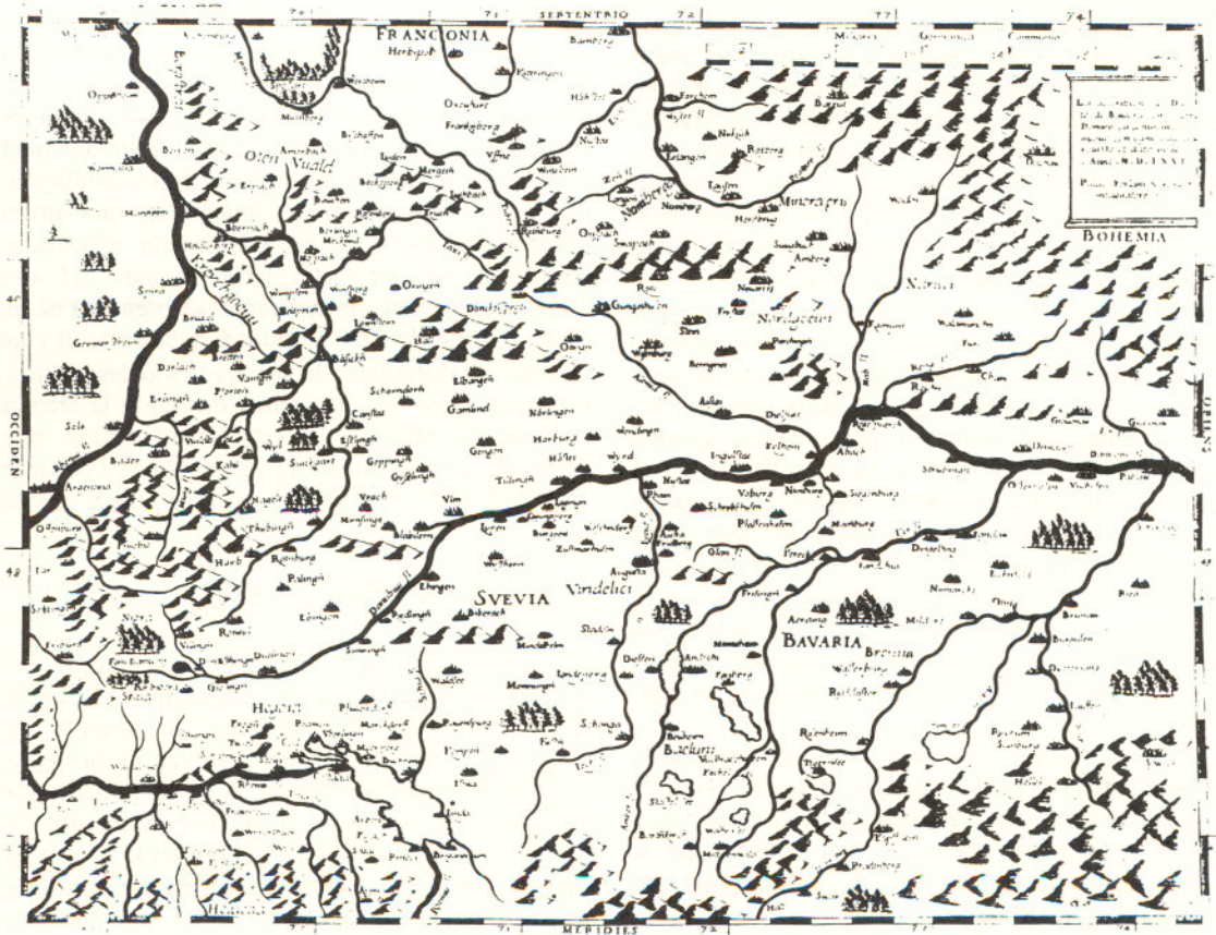
Figura N° 1: Carta de Paolo Forlani, cartógrafo italiano del siglo XVI titulada La descrizione del Ducato di Baviera (1566). Carta corográfica de esta época que antecede a los levantamientos topográficos regulares. En ella el relieve se muestra mediante el método de "toperas" o "panes de azúcar" y el emplazamiento de las localidades pobladas al estilo de las cartas de Tolomeo. Reproducida en: Die karte als kunstwerk: Dekorative lanokarten dus mittelalter und neuzeit ausstellung . Lámina N° 24.
