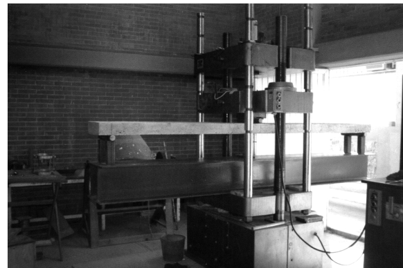
Figura 5. Montaje de uno de los especímenes en la máquina de pruebas
