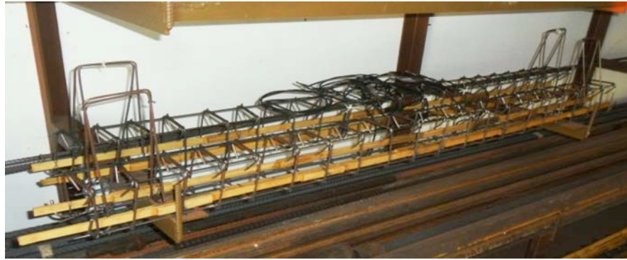
Figura 1. Vigas reforzadas con acero y con refuerzo adicional de tablillas de bambú, instrumentadas con extensómetros
